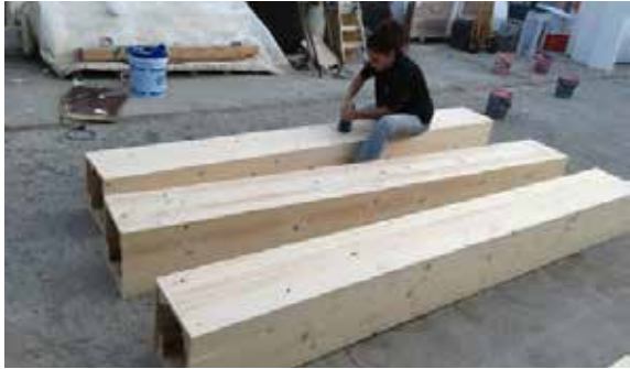
Stand Innovambienper Fiera Ecomondo. Falegnameria, costruzione stand con tavole di abete, levigate e pitturate. 2017
