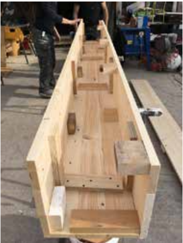
Stand Innovambienper Fiera Ecomondo. Falegnameria, costruzione stand con tavole di abete, levigate e pitturate. 2017
