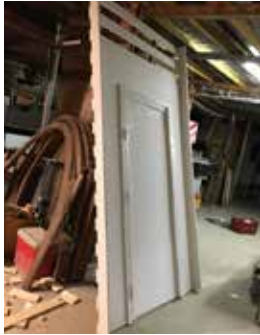
Stand Innovambienper Fiera Ecomondo. Falegnameria, costruzione stand con tavole di abete, levigate e pitturate. 2017
